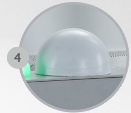
Dubbel Wi-Fi kanaal antenne (2,4/5 Ghz)
